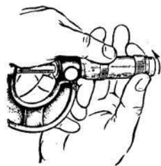
Рисунок 1.3 – закрепление барабана микрометра корпусом трещотки
